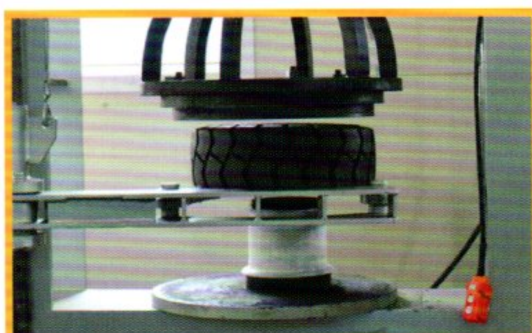
2. 타이어 상승, 프레스 작업 준비를 완료
