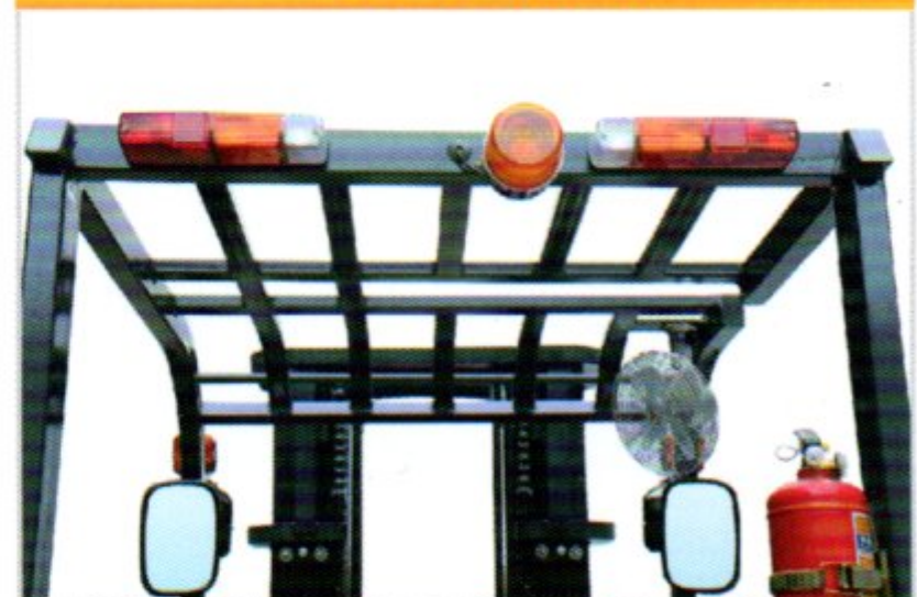
헤드라이트 및 경광등 LED 램프 장착 가능
